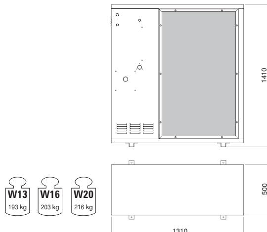
Refrigeratori di acqua glicolata con doppio sistema di regolazione del circuito frigorifero per ottimizzare le prestazioni della macchina sia in alta che in bassa temperatura. Per il funzionamento necessitano di un quadro elettrico remoto e di un serbatoio di accumulo esterno con le relative sicurezze.
